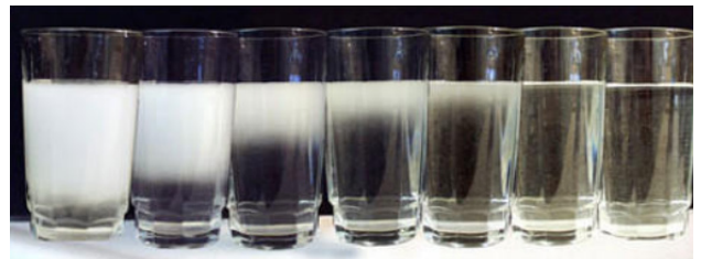
Pansamantalang presensiya ng hangin sa tubig dahil sa mga pagbabago sa temperatura at pressure ng tubig (Pinagmulan: Massachusetts Water Resources Authority, 2020)
